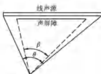
图 5.5 受声点与线声源两端连接线的夹角（遮蔽角）
